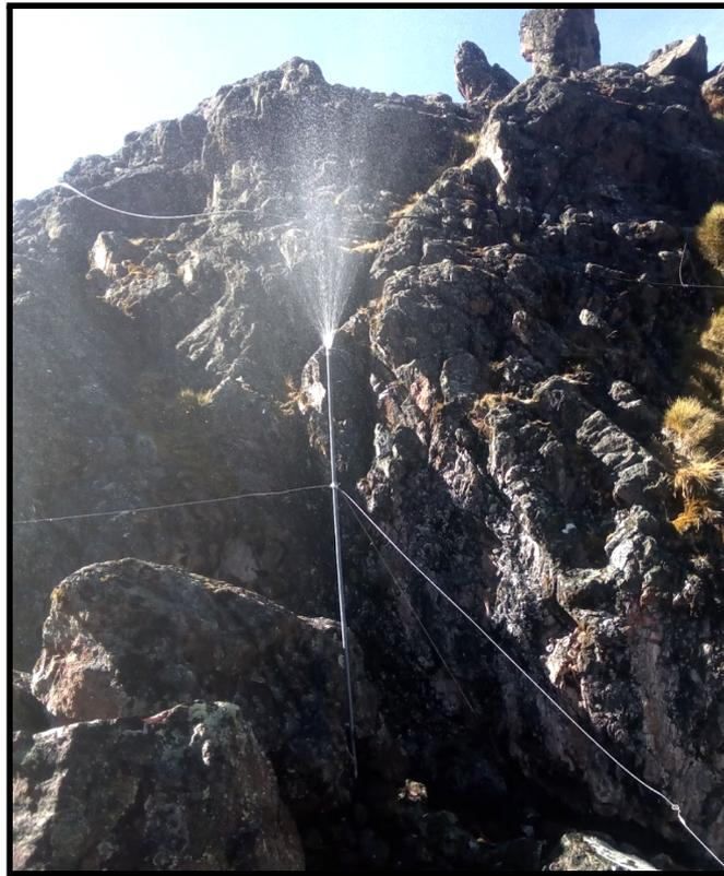
**FIGURA 23:** Prototipo 01 en forma vertical con apoyo de vientos de alambre recubierto.
