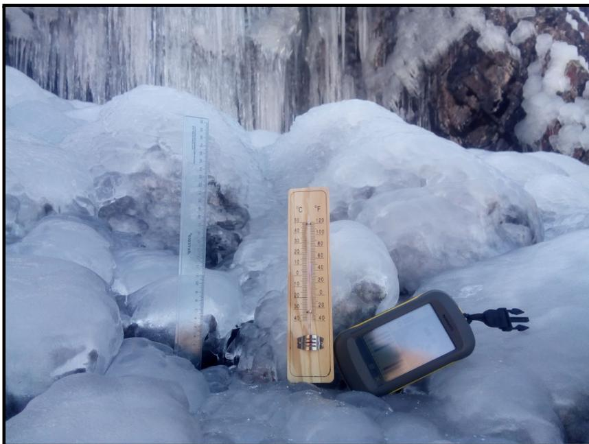
**FIGURA 36:** instrumentos de medición del glaciar artificial.
