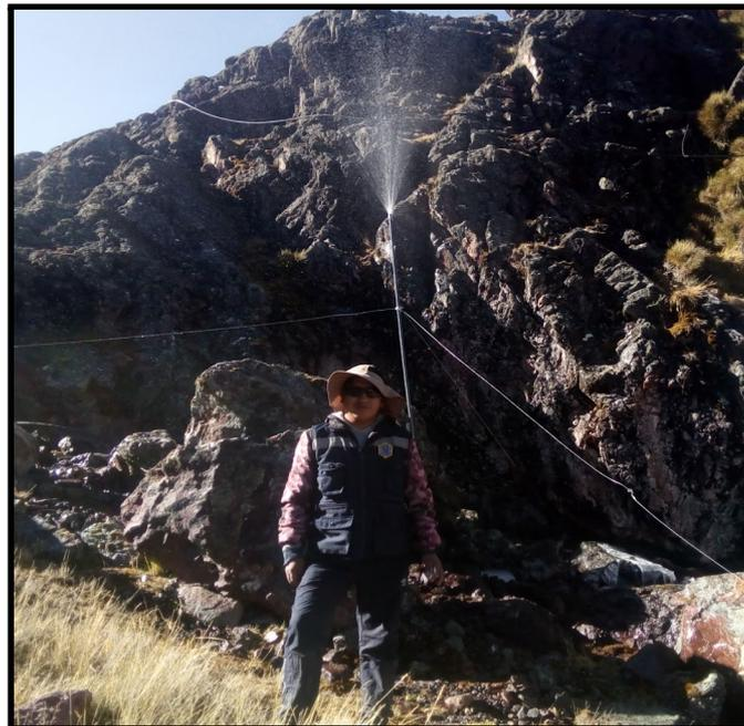
**FIGURA 24:** Prototipo 01 en forma vertical con apoyo de vientos de alambre recubierto.
